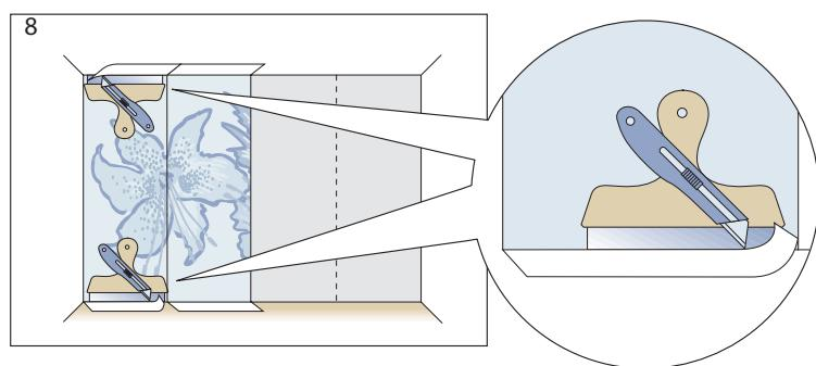
8. Отрежьте всё лишнее (инструкции, белые поверхности). Используйте в качестве подспорья для чистовой обрезки стальную линейку или широкий шпатель. Чаще меняйте лезвие обойного ножа. Тупое лезвие легко может изорвать обои.
