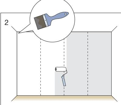
2. Нанесите клей на стену приблизительно на ширину 2-3 полос (1-1,5 метра). Важно распределить клей равномерно по всей поверхности. Из-за непромазанного клеем участка на обоях может появиться пузырь. Используйте обойную щетку в тех местах, где сложно нанести клей с помощью валика.
