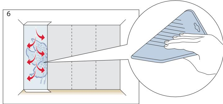
6. Используйте обойный инструмент для разглаживания обоев, а также снятия лишнего клея и пузырей. Держите инструмент в чистоте! Постоянно очищайте инструмент от клея и краски. Разглаживайте обои с помощью обойного инструмента от потолка к полу и от центра к краям.
