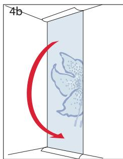
4. Прежде чем поднести полосу к стене, сложите ее пополам рисунком вовнутрь, чтобы избежать попадания клея на лицевую сторону обоев. Закрепите затем верхнюю часть на правильной высоте и в правильном положении, прежде чем начнете разворачивать всю полосу вниз.
