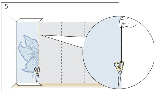
5. Прежде чем разглаживать обои по стене, убедитесь с помощью отвеса, что верхняя и нижняя части первой полосы обоев лежат вертикально. Никогда не пытайтесь сдвинуть уже приклеенную полосу обоев в каком-либо направлении. Если вы совершили ошибку, снимите полосу и начните всё сначала. Используйте при необходимости дополнительное количество клея.
